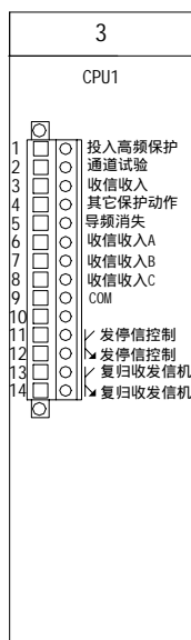
图 4.3.6.1 CPU 模件端子定义及接线图
